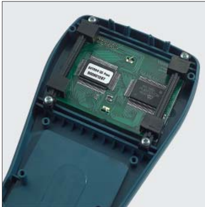
Displaybefestigungsset zur variablen Befestigung von Displays
