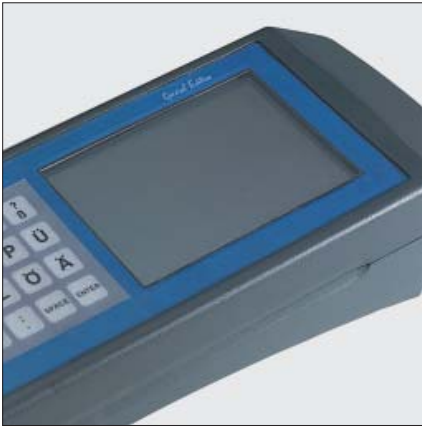
Einbau von großen Displays (1/4 VGA)
